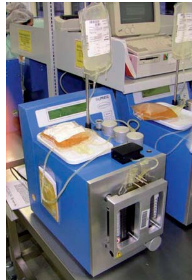
Abbildung 6 Moderner Kompomat: vorne Vollblutbeutel in der Parallelpresse, oben aufliegend Beutel mit der Plasmafraktion. Photo von Dr. Volgmann, DRK Blutspendedienst NSTOB, Institut Springe.
