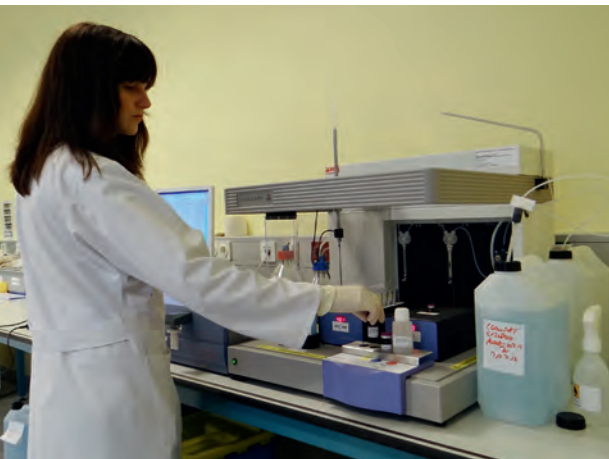
Abbildung 2 Vorbereitung des BactiFlow-Systems
