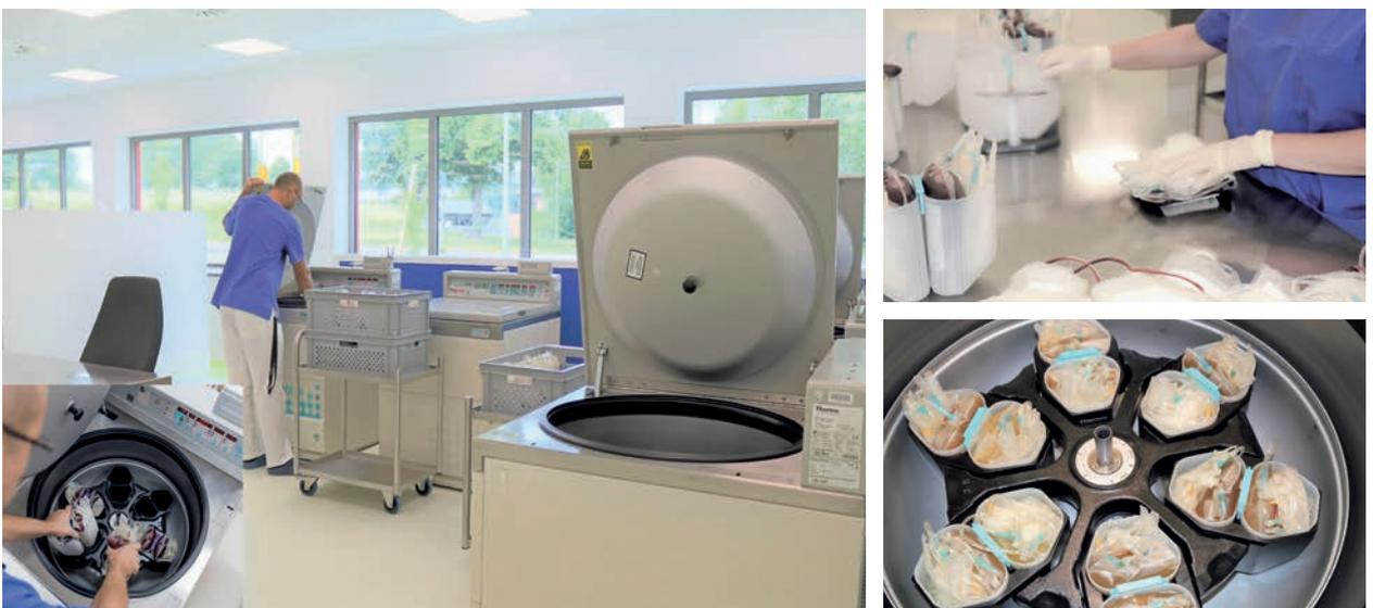
**Abbildung 6:** Bestückung von Standzentrifugen mit Mehrfach-Blutbeutel, die nach vorgegebener Packtechnik in geeignete Becher gepackt werden.
