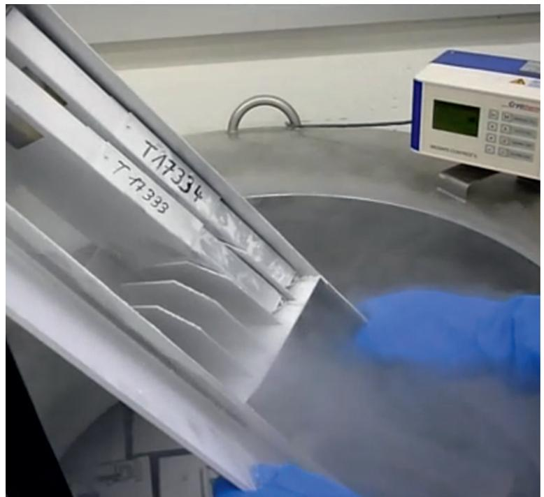
**Abbildung 4a und 4b:** Lagerung von Kryo-EK (High-Glycerol-Methode) bei  $-80\text{ °C}$  (Hagen) und in Flüssigstickstoff bei  $-196\text{ °C}$  (Ulm)
