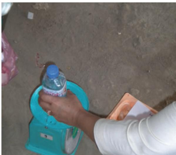
Abbildung 8: Funktionsprüfung der Blutentnahmewaage
